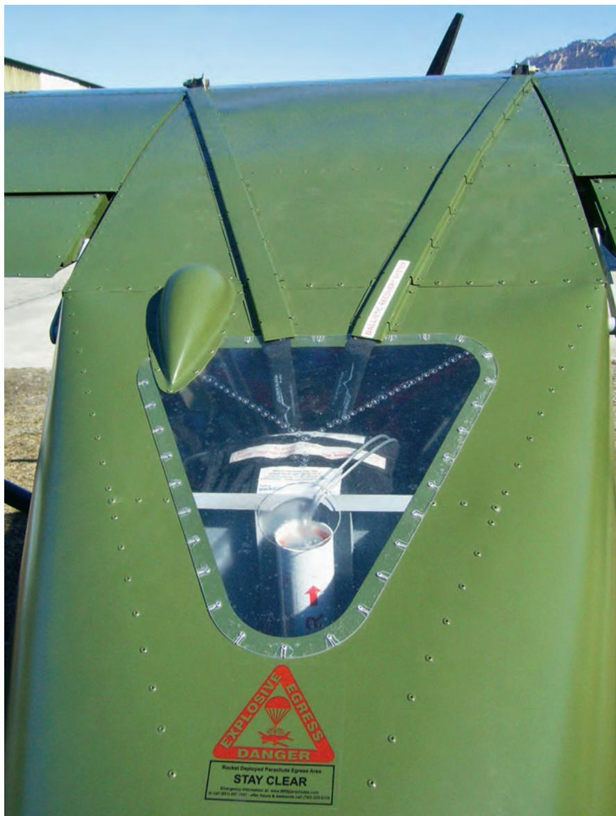
Pour ce qui concerne le Valais, l'aéronef, dont les occupants devaient être désincarcérés, perdait également du carburant. L'un des secouristes s'étant aperçu de la présence d'un BPS, il a fallu remettre en place le verrouillage de sécurité de la poignée d'armement du parachute balistique avant de démonter, sur toute sa longueur, le système de support du câble et la poignée afin de permettre la découpe du toit pour accéder aux blessés.
